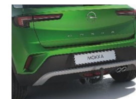
Vlečna kljuka, snemljiva brez orodja + 13-polni konektor
