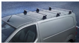
Prečni strešni aluminijasti nosilec, 1 kos (obremenitev z 2 palicama 100€, 3 palicami 150kg)
