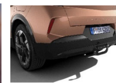
Vlečna kljuka, snemljiva brez orodja + 13-polni konektor
