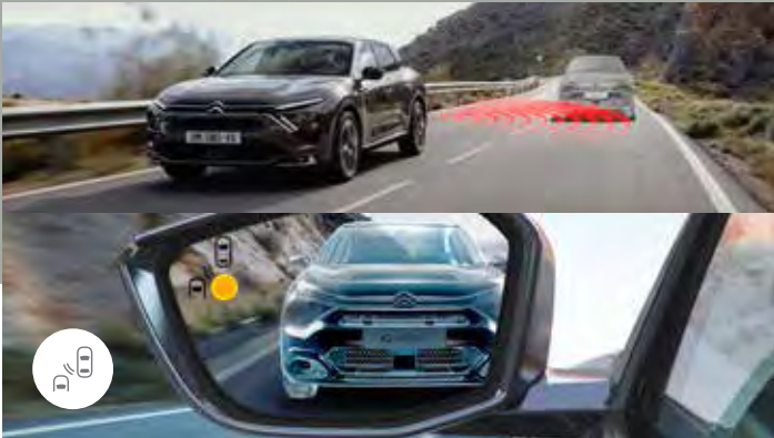
SISTEM ZA NADZOR MRTVEGA KOTA Z DOLGIM DOSEGOM* Sistem, ki je v veliko pomoč med vožnjo po hitri cesti in avtocesti, vozniku sporoča prisotnost vozila v mrtvih kotih do 70 metrov za vozilom C5 X z oranžno lučko, ki zasveti v kotu zunanjih ogledal.
