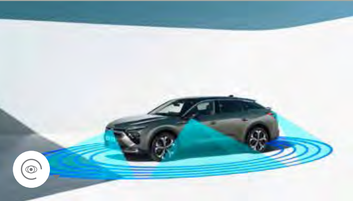
VISION 360* Video pomoč za izvajanje vseh manevrov pri nizki hitrosti se vklopi samodejno ob preklopu v vzratno prestavo ali pa jo lahko ročno vklopi voznik. Na zaslonu na dotik prikaže sliko z zgornjega dela vozila C5 X in njegove okolice pod kotom 360° po zaslugi štirih kamer visoke ločljivosti.
