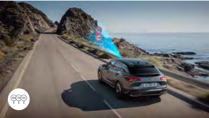
RAZŠIRJENI SISTEM ZA PREPOZNAVANJE PROMETNIH ZNAKOV IN PRIPOROČILO O OMEJITVI HITROSTI* Sistem obvešča o omejitvi hitrosti, ki jo je potrebno upoštevati. Ko kamera zazna prometni znak za omejitev hitrosti, lahko voznik priporočeno hitrost sprejme in si jo nastavi za vrednost tempomata oziroma omejevalnika hitrosti. Zaznava tudi prometne znake "Stop", "enosmerna cesta" in "prepovedano prehitevanje".
