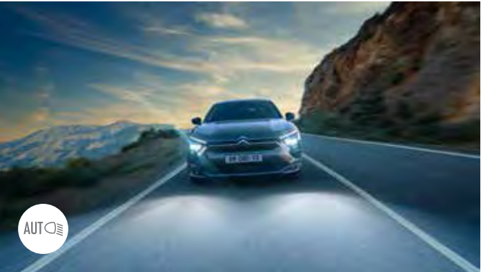
SAMODEJNI PREKLOP DOLGIH LUČI* Ta funkcija upravlja preklapljanje med dolgimi in zasenčenimi lučmi glede na to, ali v prometu zazna vozila, ki vozijo nasproti oziroma nas prehitevajo. Sistem nudi optimalno osvetlitev med vožnjo ponoči.
