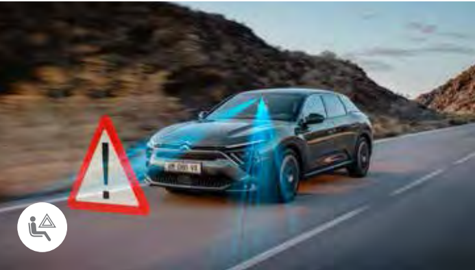
AKTIVNI OPOZORILNIK NA NENAMERNO MENJAVO VOZNEGA PASU Sistem deluje s pomočjo kamere, ki prepozna prekinjene oziroma neprekinjene črte. V primeru približevanja talni črti brez vključenih ustreznih smernih kazalcev volan postopoma obrača v drugo smer, da bi vozilo ohranilo na trenutnem voznem pasu. Ta sistem pomaga preprečevati nezbranost voznika.
