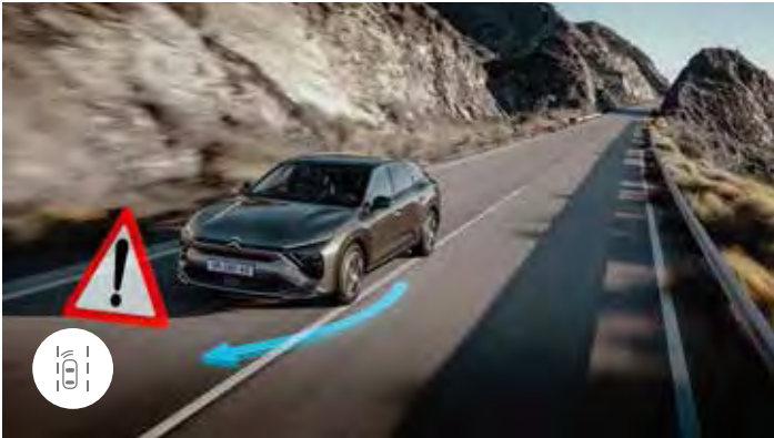
OPOZORILNIK NA VOZNIKOVO NEPOZORNOST Sistem ocenjuje stanje voznikove pozornosti prek ugotavljanja odstopanj v smeri vožnje glede na talne označbe. Funkcija je še posebej prilagojena hitrim cestam in hitrosti višji od 65 km/h.
